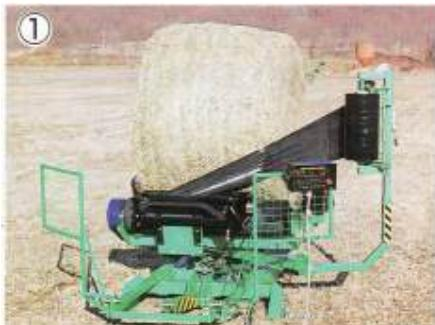
フィルムマストが旋回しテーブルは回転しないために、安定した早いラッピング作業を実現
