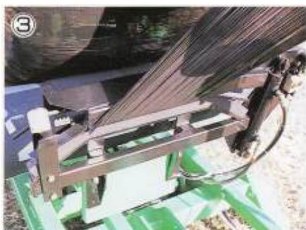
フィルムは自動カットされ、フィルムの先端はカッティング装置で保持される
