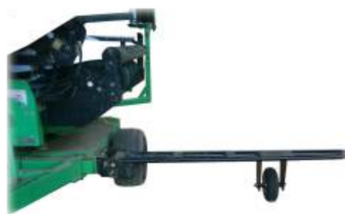
縦おろしキット取付け時
