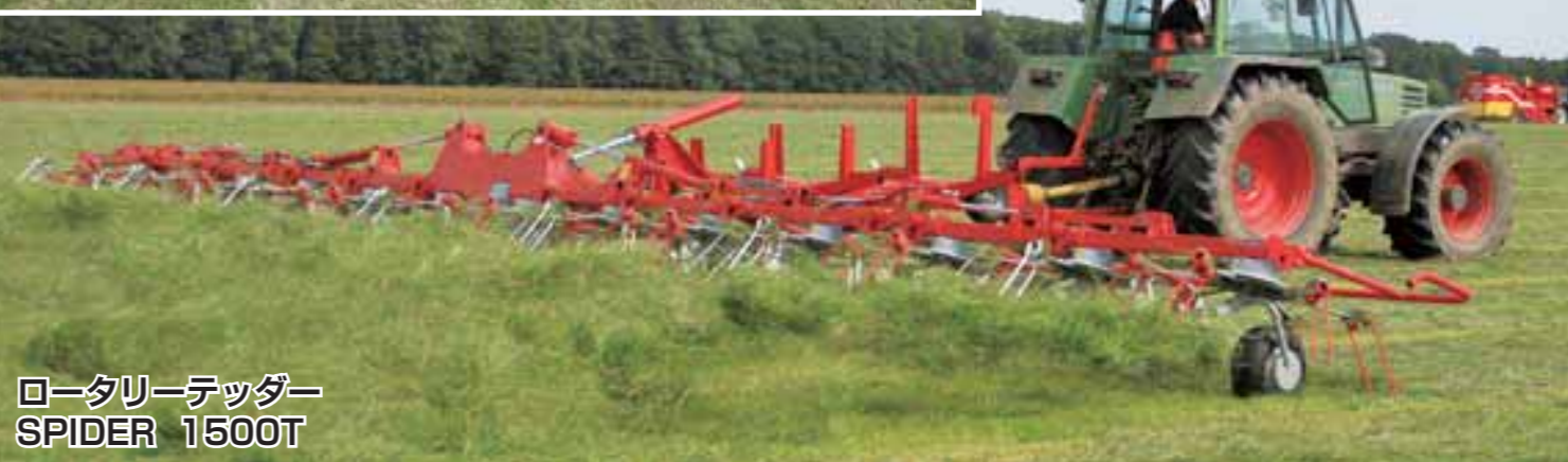
小径ローターによる理想的な反転・拡散
